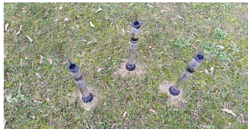
FIGURA 4. UTILIZZO DEGLI INFILTROMETRI A DEPRESSIONE MINIDISK DURANTE LA MISURA DELLA CONDUCIBILITÀ IDRAULICA INSATURA.
