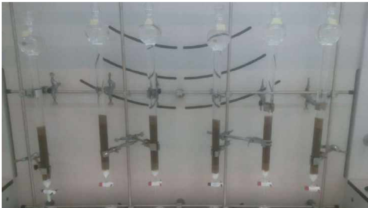
Figura 9.1 – Colonne di suolo contaminato per studiare in laboratorio la mobilità di PCB e prodotti intermedi
