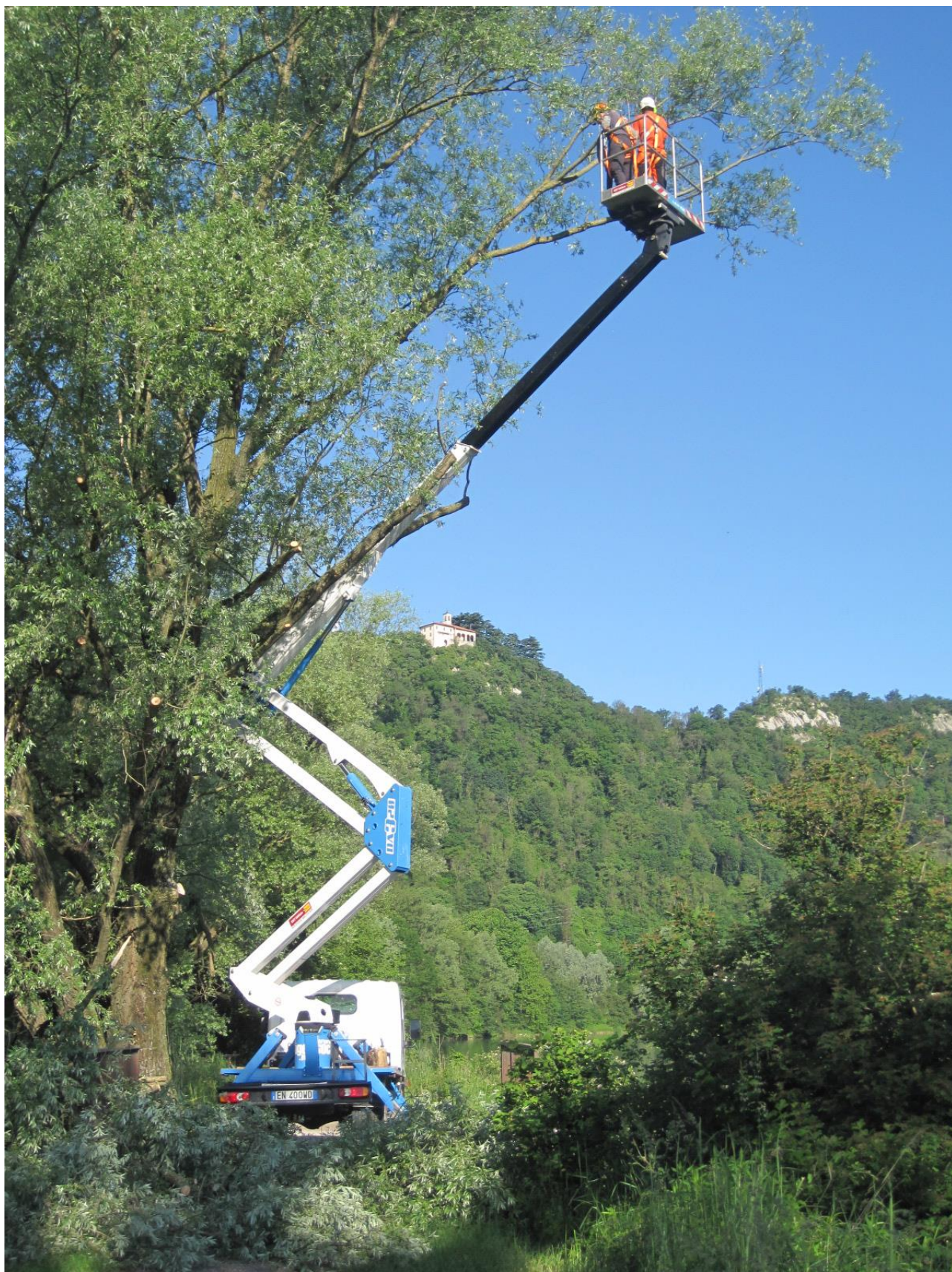
fig. 2 – potatura di branche a rischio di schianto con piattaforma aerea
