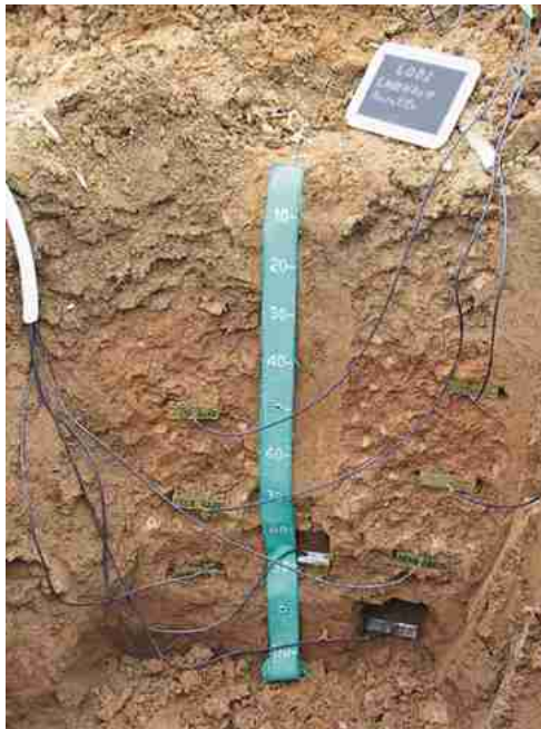
Figura 3.2 installazione delle sonde TDR
