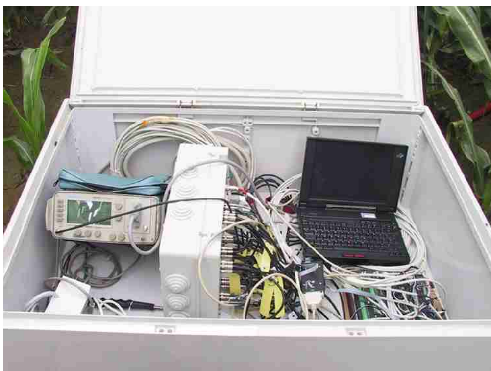
Figura 3.1 Esempio di sistema di campo di una stazione di monitoraggio
