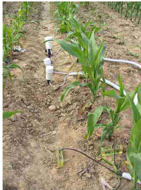
Figura 3.3 installazione dei tensiometri
