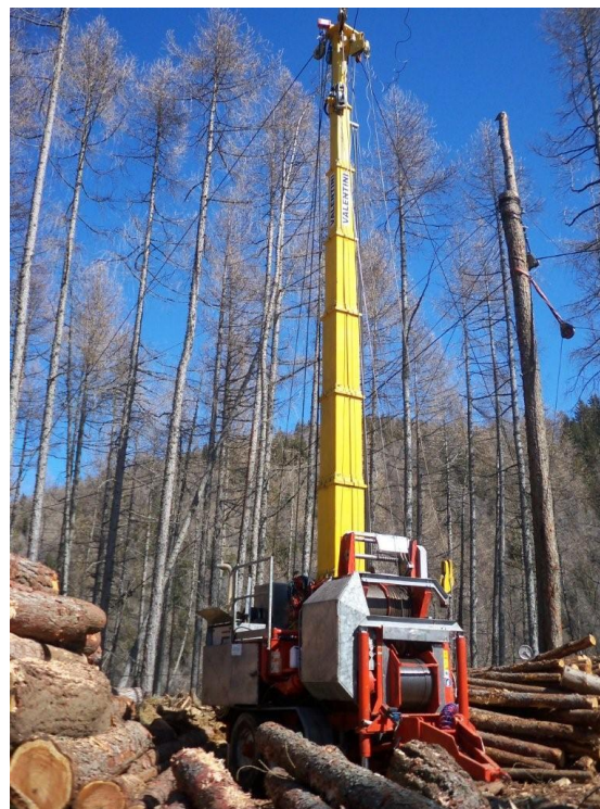
Operazioni di esbosco con gru a cavo con torretta mobile (Foto di Giulio Zanetti).
