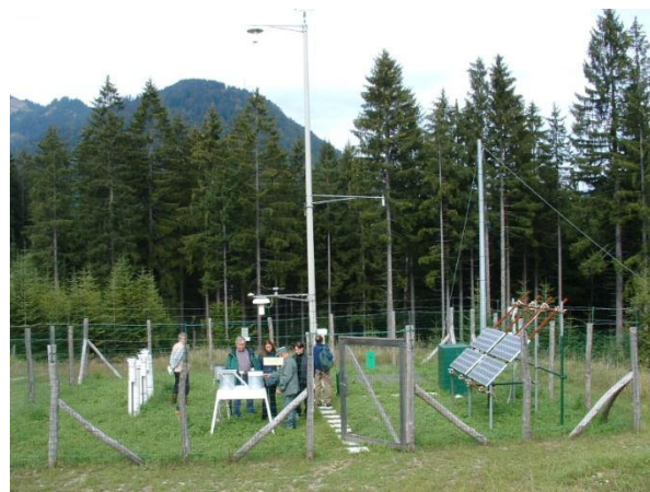
Centralina di rilevamento dati meteorologici, rete di monitoraggio CONECOFOR, Tarvisio (UD) Friuli-Venezia Giulia
