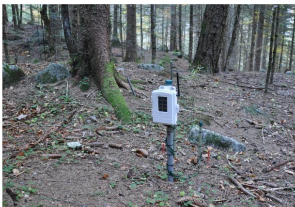
Strumentazione per il rilevamento dell'umidità e della temperatura al suolo, a 15 cm e 30 cm di profondità, allestita nell'area LOM1, nella Foresta Regionale Val Masino (SO).
